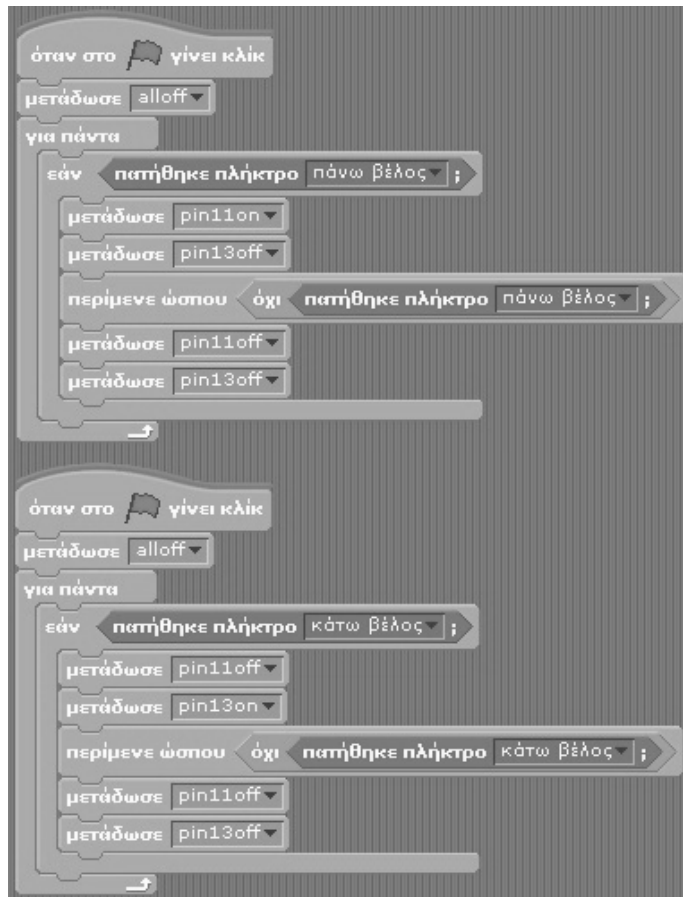
Εικόνα 6. Εντολές χειρισμού κινητήρα DC στο Scratch GPIO.
